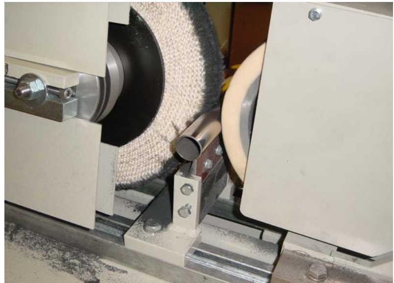
Polierscheibenaggregat mit spezieller einseitig gelagerten Antriebswelle zum schnellen Auswechseln von Sisal-, Polier-, Vlies- oder gummigebundenen Scheiben und Winkeleinstellung über Spindel
