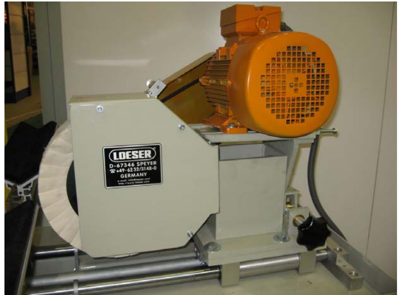
Polierscheibenaggregat mit spezieller einseitig gelagerten Antriebswelle zum schnellen Auswechseln von Sisal-, Polier-, Vlies- oder gummigebundenen Scheiben und Winkeleinstellung über Spindel
